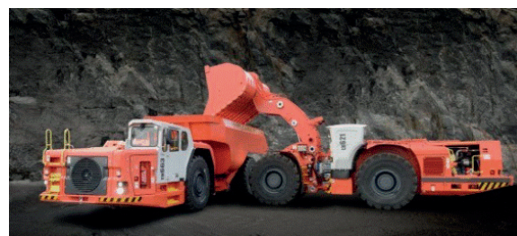
Рис. 15. Механическое взаимодействие между машиной LHD и подземным грузовиком [6]
