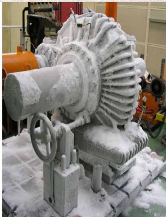
部件低温试验 Испытание деталей при низкой температуре
