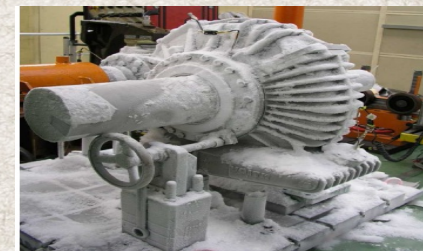
低温试验 Испытание при низкой температуре
