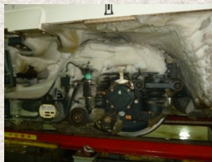
国内动车组积雪结冰 Занос и обледенение китайских подвижных составов
