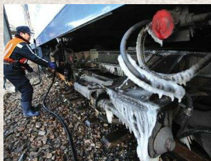
国内普通铁路客车积雪结冰 Занос и обледенение китайских обычных поездов
