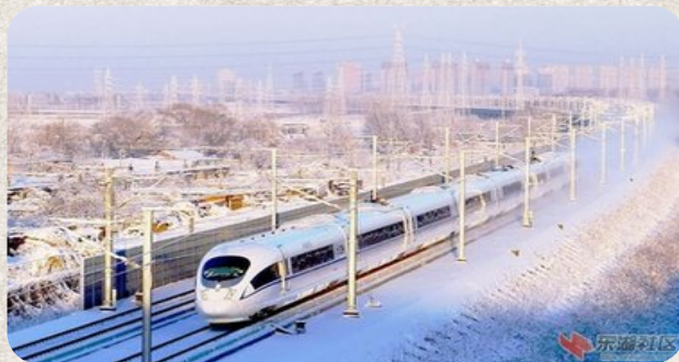
CRH380BG型高寒动车组运行在哈大线 Эксплуатация морозоустойчивого электропоезда CRH380BG на ВСМ Харбин-Далянь
