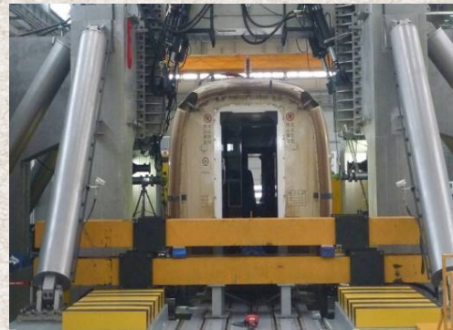
整车模态试验 Испытание на модальность целого поезда
