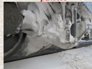
国外动车组积雪结冰 Занос и обледенение зарубежных подвижных составов
