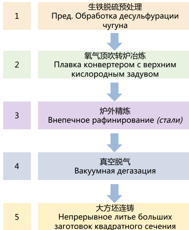
钢轨的转炉冶炼 конвертерное производство
