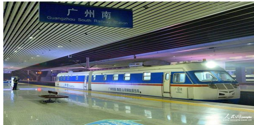
高速铁路钢轨探伤车 вагон-дефектоскоп ВСМ
