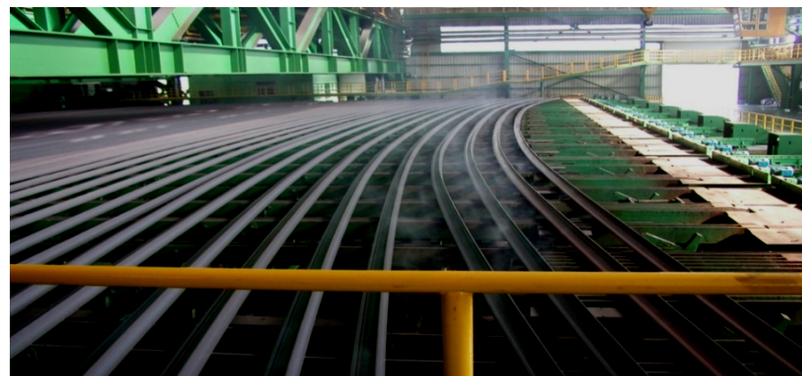
钢轨热预弯 горячий пред.прогиб рельса
