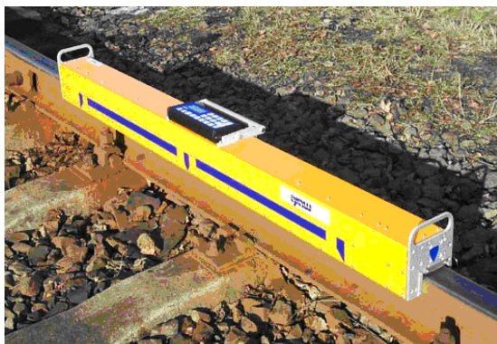
钢轨平直度测量仪 измерительный прибор прямолинейности рельса
