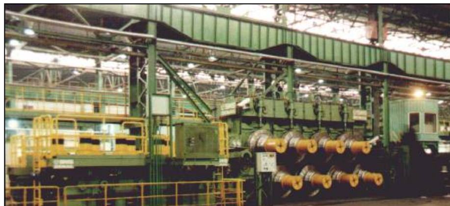
钢轨平立复合矫直 комплексная правка в плане и в вертикальной плоскости рельса
