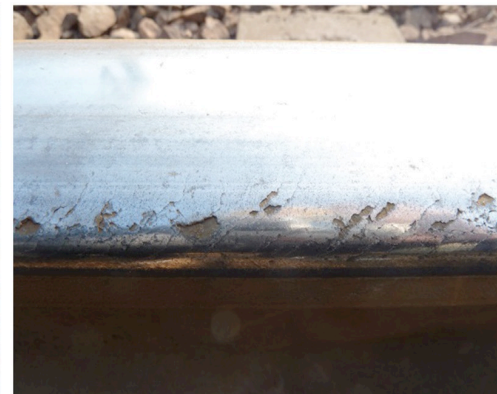
钢轨磨耗 Износ рельса
