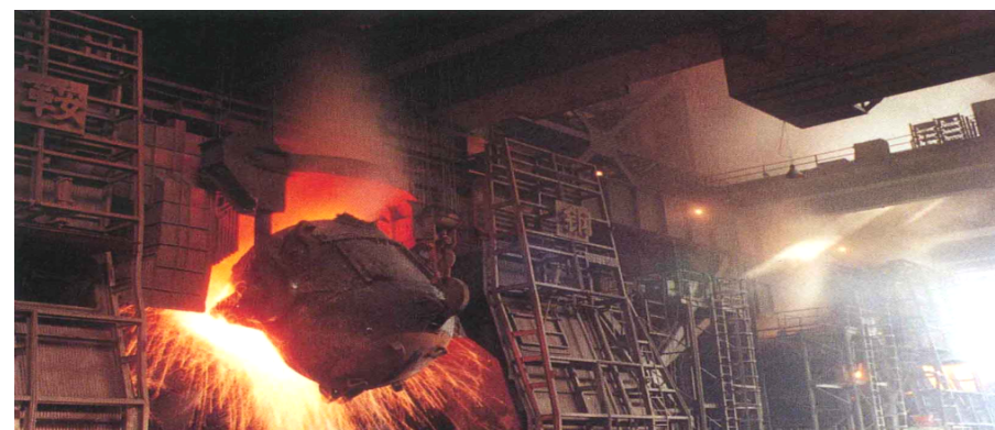
钢轨的四流方坯连铸 непрерывная разливка рельса четыре заготовки квадратного сечения
