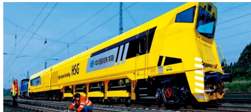
高速铁路快速打磨车 вагон быстрой шлифовки ВСМ
