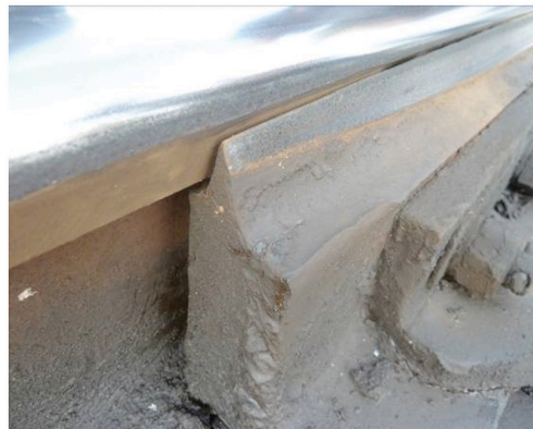
钢轨磨耗 Износ рельса
